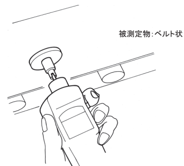
速度計測ホイルを取付けての速度計測
